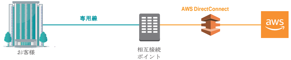
図 3.1 Direct Connect の概要
